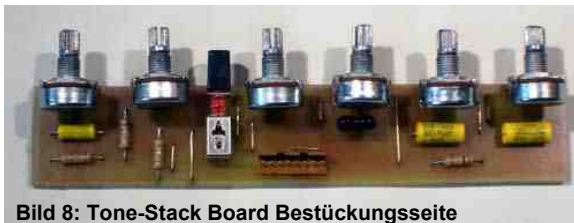
Bild 8: Tone-Stack Board Bestückungsseite
