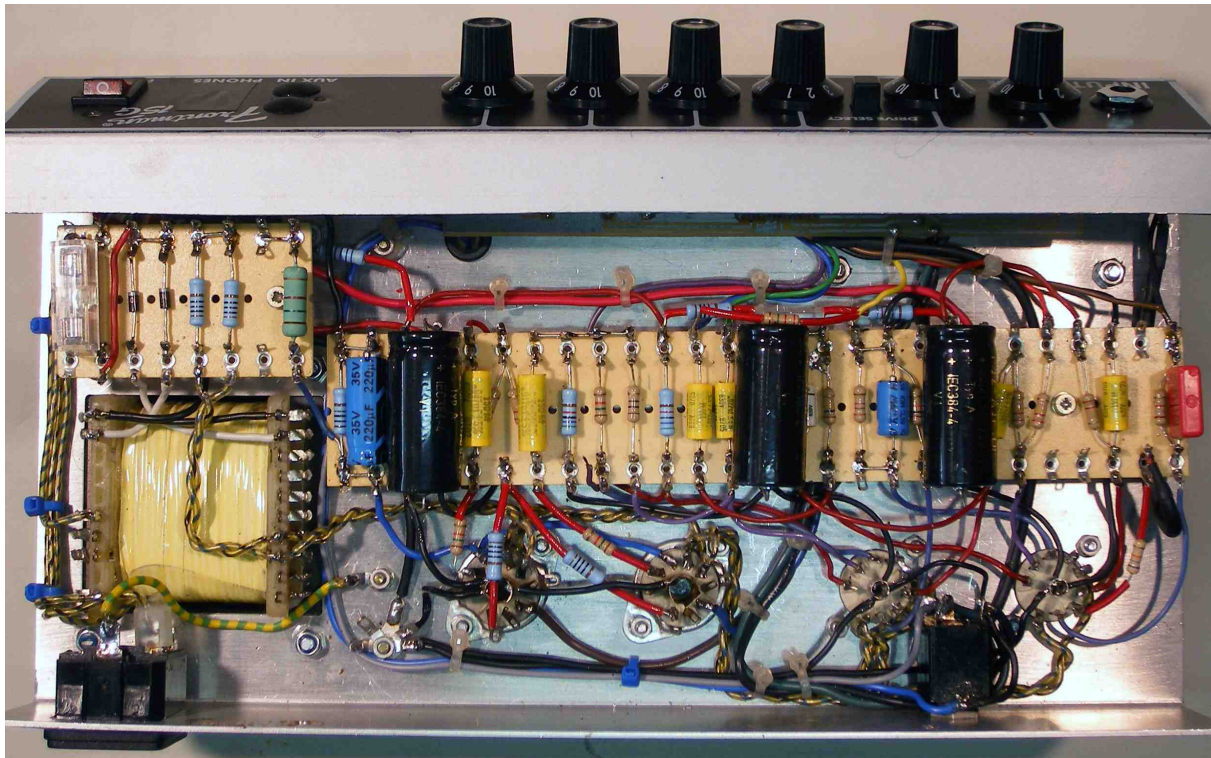
Bild 11: Fertig verkabeltes Chassis
